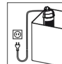
При использовании распределительной розетки ее следует разместить над сетевым разъемом фильтра.
