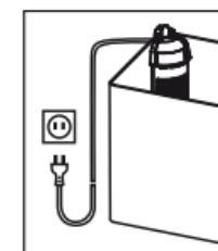
Bei Verwendung einer Verteiler-Steckdose muss die Platzierung oberhalb des Filter-Netzanschlusses erfolgen.
