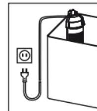
使用接線板時，必須將它置於過濾器的電源介面的上方。
