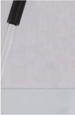
Fig. 5 : Le tuyau de remplissage doit être placé au-dessus de la surface de l'eau. En cas de fin de tuyau immergé de l'eau pourrait couler du bac de filtration vers le réservoir ou inversement selon le principe des vases communicants, jusqu'à égalité des niveaux. En outre, pour la même raison, le réservoir ne doit pas être plus haut que la sortie du tuyau de remplissage, car l'eau pourrait couler de manière non contrôlée.
